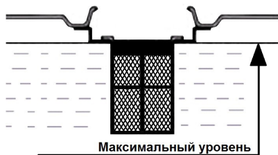
Рис. 8 Максимальный уровень топлива в топливном баке
